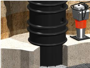
Rellenar con material de aportación (arena o gravilla fina lavada, cribada y libre de polvo), dejando momentáneamente los últimos 50cm de la base libres para conectar con la siguiente pieza. El relleno debe ser colocado de forma uniforme en tongadas de unos 30cm.
