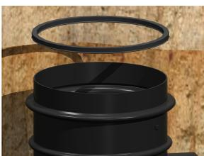
Colocar la junta en U, limpia y lubricada, en la base del pozo RASAN. Esta junta se debe colocar siempre de forma que el lado que tiene la pestaña quede por el interior del pozo.
