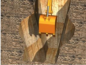
Excavar una zanja lo suficientemente grande para garantizar la estabilidad de la misma. Como mínimo se dejarán 40cm entre las paredes de la excavación y el pozo y la distancia mínima entre pozos será de 50cm.
